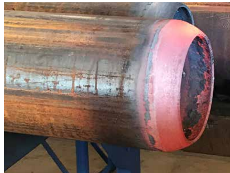
buisdeel wordt koud of warm getrompt
